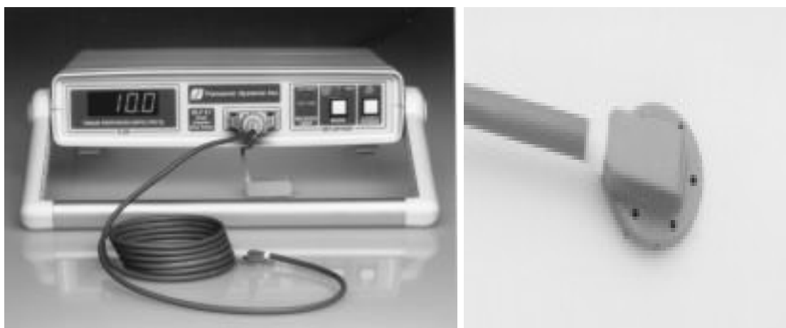
Рис. 7. Внешний вид BLF21 Laser Doppler Flowmeter Transonic и датчик типа R.
